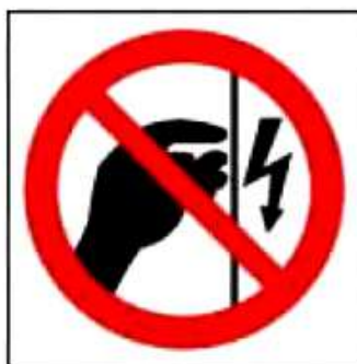
P09 Запрещается прикасаться. Корпус под напряжением
