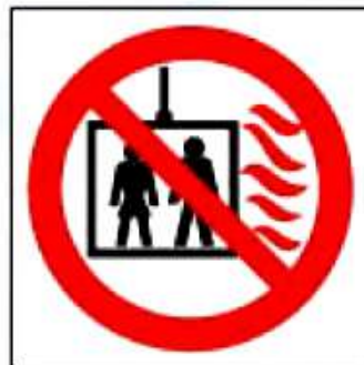
P44 Пользование лифтом во время пожара запрещено
