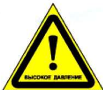
W33 Осторожно. Высокое давление
