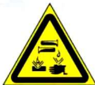
W04 Опасно. Едкие и коррозионные вещества
